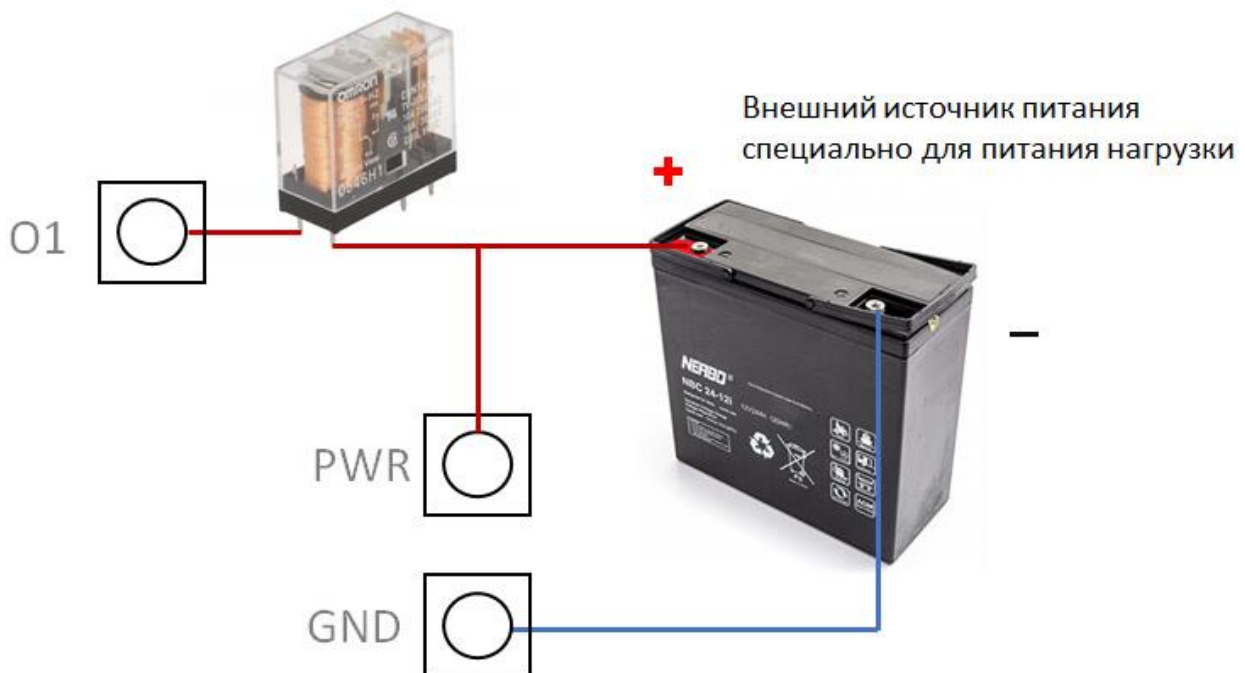
Рис. Подключение внешнего реле на +24 В. В данном случае рассмотрим ситуацию, когда питание нагрузки осуществляется независимым источником питания.
