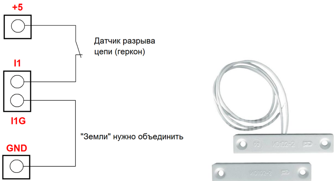
Рис. Объединение земли модуля и оптоизолированной земли входной линии при использовании источника питания модуля или встроенного стабилизатора питания в качестве источника сигнала. Например, такая схема может быть удобна при использовании герконовых датчиков.
