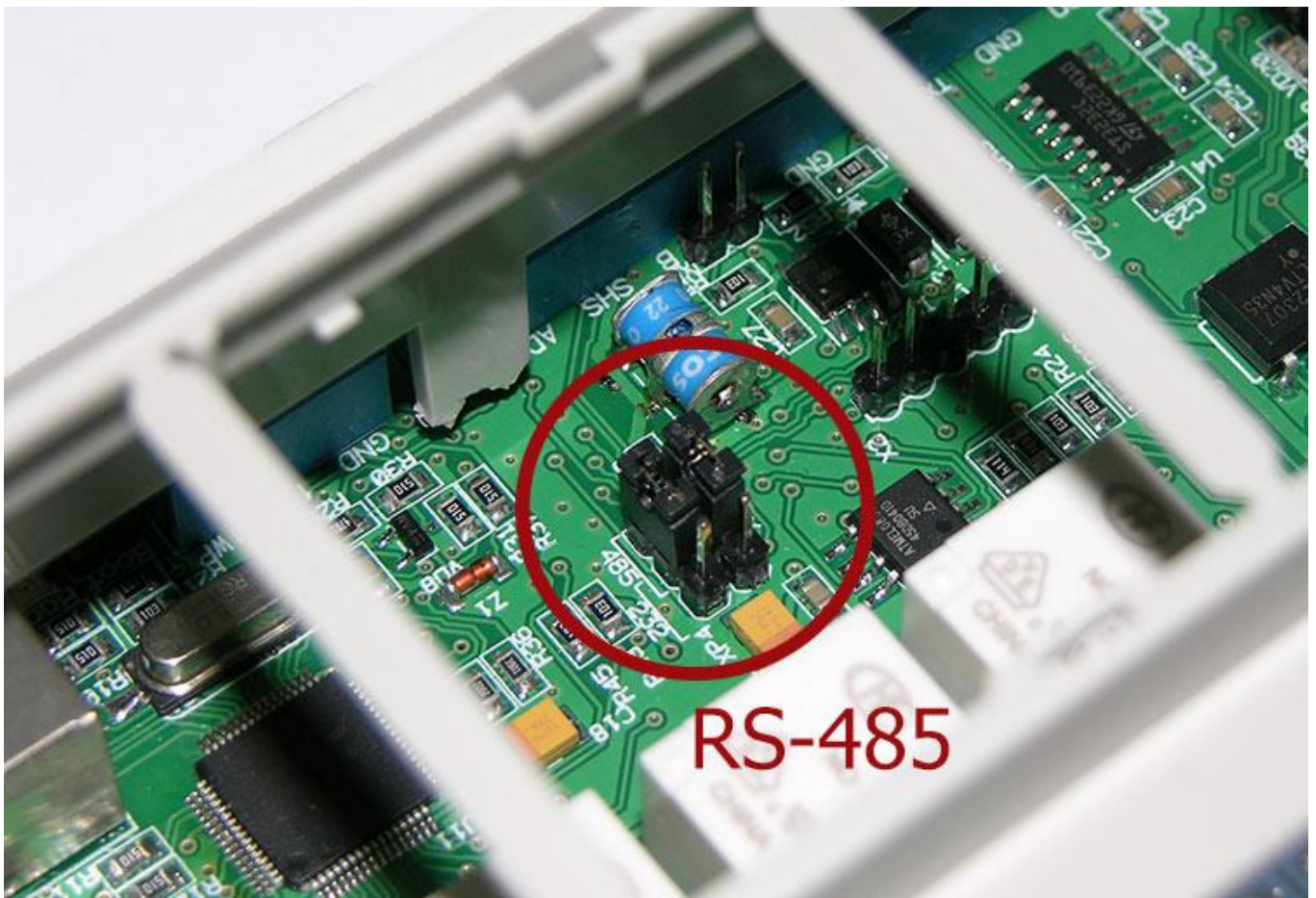
Рис. Конфигурация джамперов для выбора интерфейса RS-485 (снята верхняя крышка корпуса модуля).
