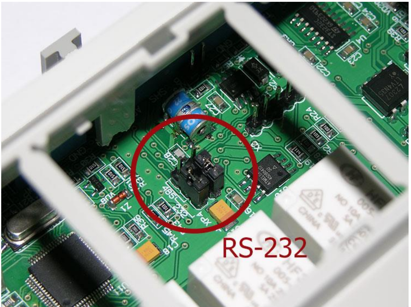
Рис. Конфигурация джамперов для выбора интерфейса RS-232 (снята верхняя крышка корпуса модуля).
