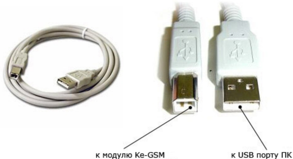
Кабель USB-AB для подключения модуля к компьютеру.
